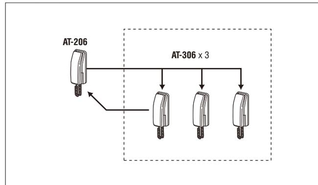
主机可同时呼叫所有的分机，而分机只能振铃呼叫主机。
